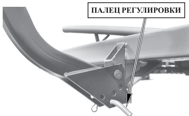
Регулировка бокового поручня на модели 1400
