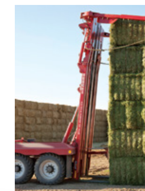
Рулевое управление со сцепкой позволяют оператору хорошо видеть квадратные тюки и выравнивать их перед стогованием.
