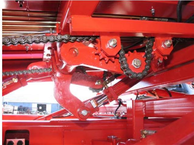
Tensión de deslizamiento de cadena
