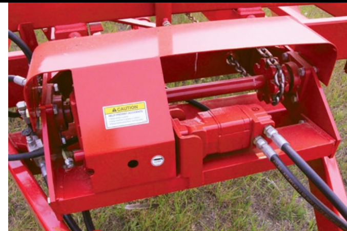
Высокопроизводительный гидромотор с большим крутящим моментом обеспечивает гладкую работу толкателя даже с самыми высокими требованиями к загрузке.
